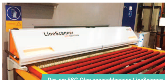
Der am ESG-Ofen angeschlossene LineScanner www.glass-iq.com
