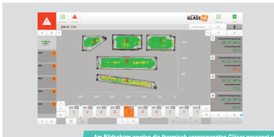
Am Bildschirm werden die thermisch vorgespannten Gläser gescannt und ausgewertet
